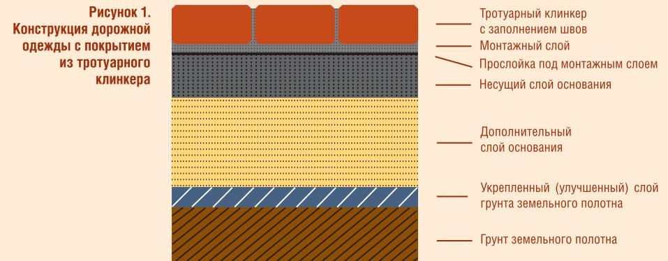
**Несущее основание** – часть дорожной одежды, обеспечивающая совместно с покрытием перераспределение и снижение давления на нижележащие дополнительные слои или грунт земляного полотна. Основание может быть выполнено из различных материалов: щебня, укладываемого с расклинкой; песко-цементной смеси; щебня, укрепленного цементом или расклинцованным песко-цементной смесью или других материалов, модуль упругости которых превышает 180 МПа.
